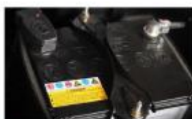
VRLA-AGM bezobsługowe baterie
